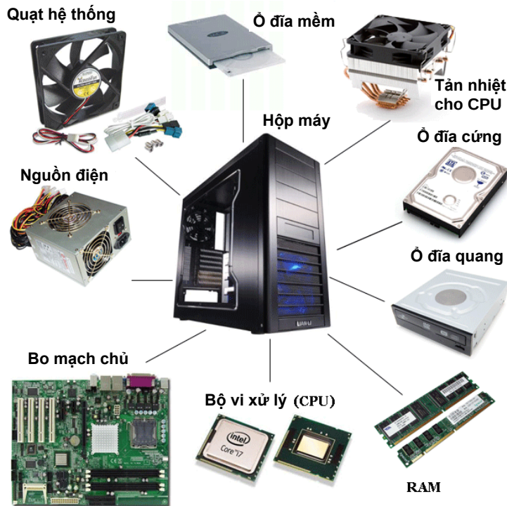
Hình 2.4. Các thành phần phổ biến bên trong hộp máy tính cá nhân
